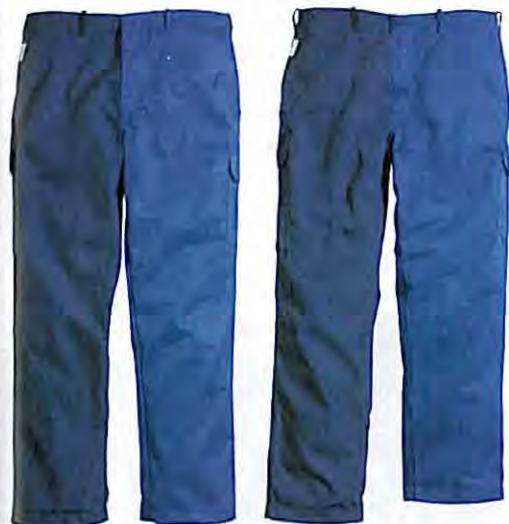
Bild 1 Schrumpfverhalten beim Vergleich zwischen Crossfire (linkes Hosenbein) und vergleichbarem Gewebe (rechtes Hosenbein); links: vorher, rechts: nach zehn Wäschen.
