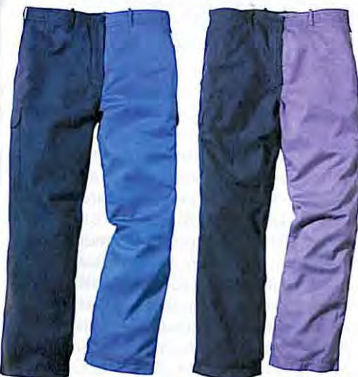
Bild 2 Farbverhalten beim Vergleich zwischen Crossfire (linkes Hosenbein) und vergleichbarem Gewebe (rechtes Hosenbein); links: vorher, rechts: nach 30 Wäschen.
