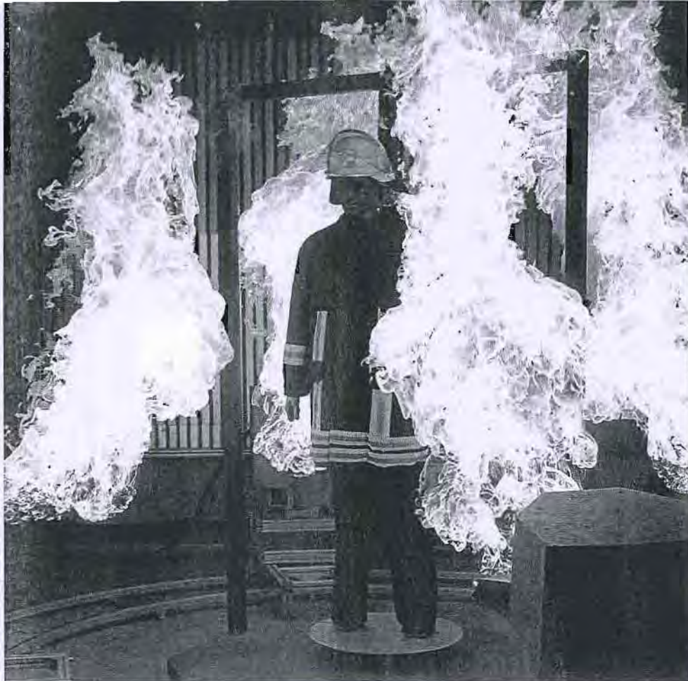
Beflammt: Bei der Prüfung zum Flammenschutz wird die Feuerwehrkleidung (EN 469) und Schutzkleidung (ISO 11612) 10 Sekunden beflammt – danach darf die Probe maximal 2 Sekunden weiter brennen bzw. weiter glühen.
